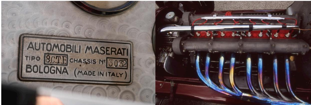
Le châssis adopta la disposition-type des monoplaces de l'époque, avec deux barres profilées en acier et des traverses. La voiture quant à elle, eut un moteur droit à 8 cylindres en deux groupes de 4, coulé dans un monobloc avec la culasse : d'où le nom "8CTF", ou 8 cylindres "Testa Fissa" - tête fixe.
